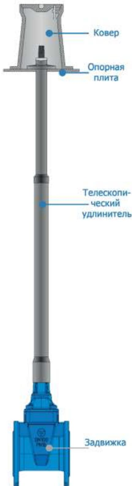
**Телескопический удлинитель штока** предназначен для управления трубопроводной арматурой, установленной безколодежным способом. Регулируемая длина штока позволяет настраивать его если расстояние от верха трубопроводной арматуры до поверхности земли не определено. Конический переходник рассчитан на стандартный Т-образный ключ.
