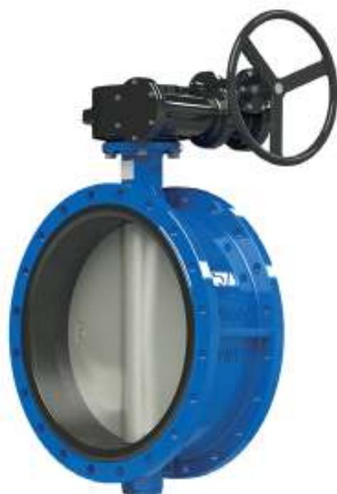
**Затвор дисковый фланцевый тип RVB 05** предназначен для полного перекрытия и регулирования потока рабочей среды в технологических и магистральных трубопроводах. Конструкция затвора позволяет применять на трубах из ПНД, ПЭ с зауженным внутренним диаметром. Обеспечивает класс герметичности «А» в обоих направлениях потока.
