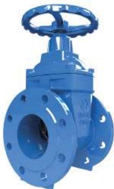
**Задвижка фланцевая с обрезиненным клином тип RVG 10 с невыдвижным шпинделем** является одним из распространенных типов трубопроводной арматуры. Предназначена для полного перекрытия рабочей среды в технологических и магистральных трубопроводах. Обеспечивает класс герметичности «А» в обоих направлениях потока.
